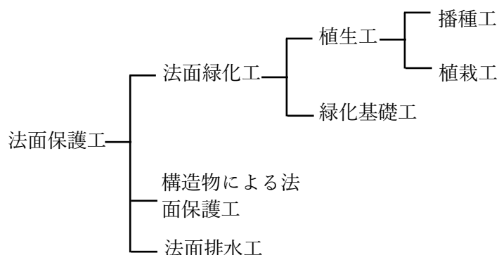
図 3-47 法面保護工の分類
