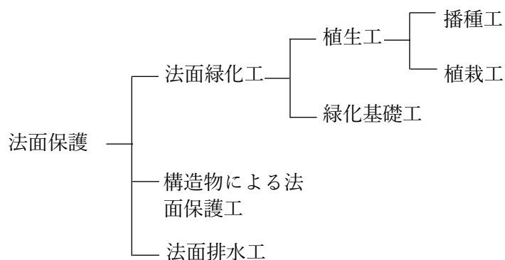
図 3-54 法面保護工の分類
