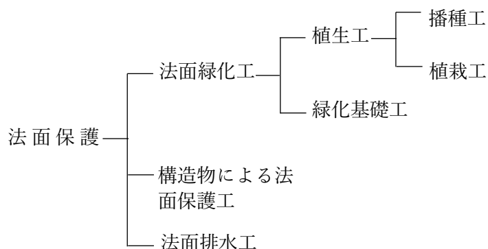
図 3-58 法面保護工の分類
