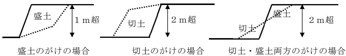
注) 既存のがけが 1 m 未満であっても、新たな盛土により 1 m を超えるがけが生じる場合、既存のがけが 2 m 未満であっても、新たな切土、切土・盛土両方により 2 m を超えるがけが生じる場合、許可が必要となる。
