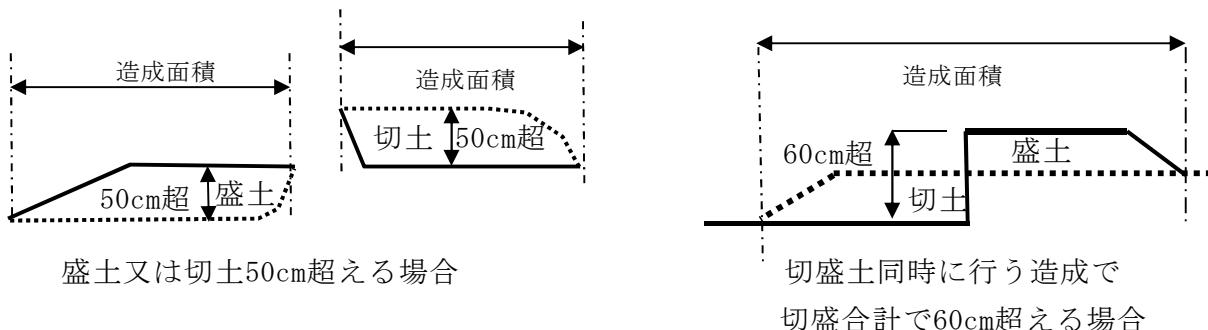
注) 実線は造成後の地盤面、破線は造成前の地盤面
