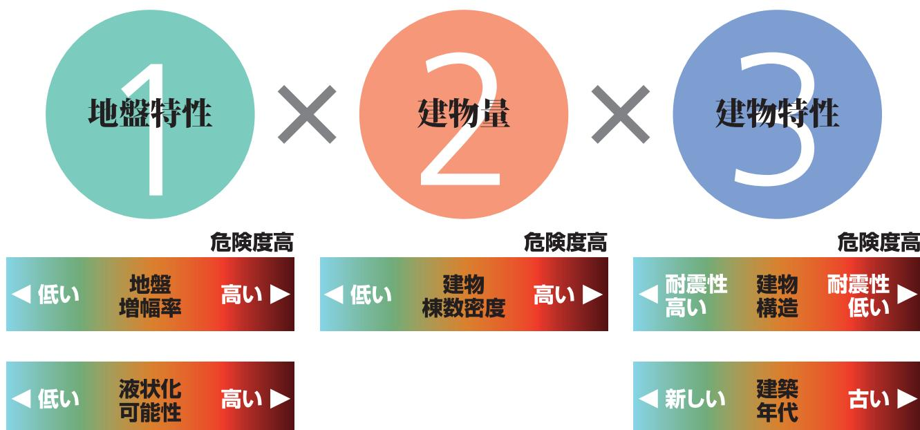
建物倒壊危険量は、分類ごとに集計した建物量に、**地盤特性**と**建物特性**ごとの建物被害率を掛け合わせることにより、測定しています。建物量は、町丁目ごとに、建物棟数を構造（木造・RC造・S造等）及び建築年代といった**建物特性**別に集計しています。地盤特性は、左記「地盤分類図」により、町丁目別に12種類の地盤に分類し、各地盤分類について、地盤の揺れやすさを示す增幅率を設定しています。また、沖積低地での地盤の液状化や丘陵地での大規模盛土造成地の影響も考慮しています。建物被害率は、阪神・淡路大震災や熊本地震などの過去の地震被害の調査事例などを基に設定し、耐震改修等の実績を考慮しています。
