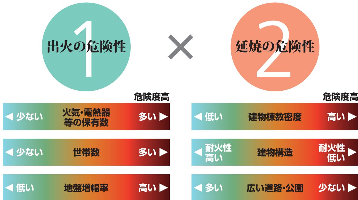
火災危険量は、**出火の危険性**と**延焼の危険性**を掛け合わせることにより測定しています。
