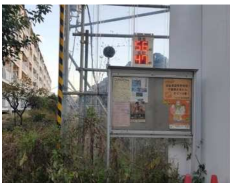
図9-1 騒音振動計の移設
