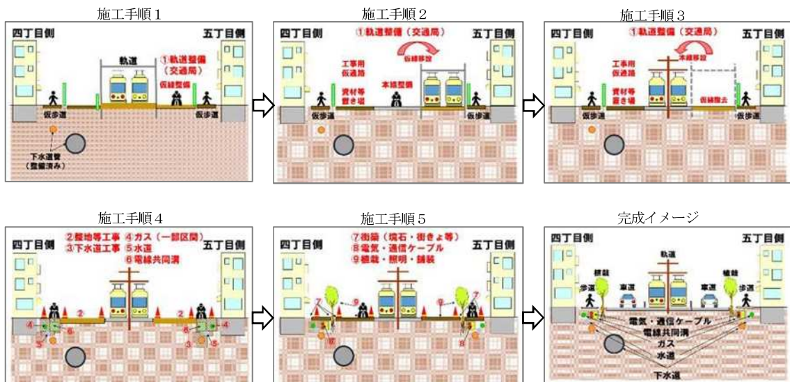
図8 軌道移設工事 施工手順
