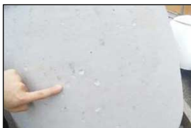
図 11 人孔材料の傷の映像
