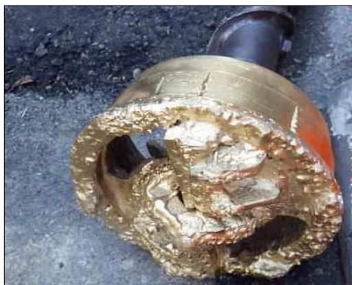
図 13 低耐荷力泥土圧式工法【切削ビット】
