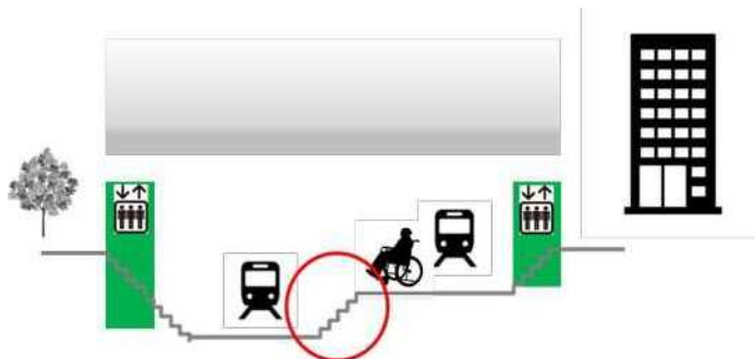
図8 乗換動線上に残る障害
